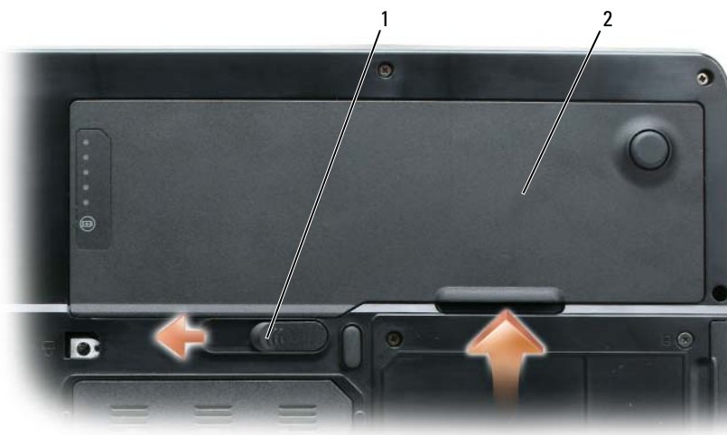
1 Frigöringsspak för batterifacket 2 Batteri
