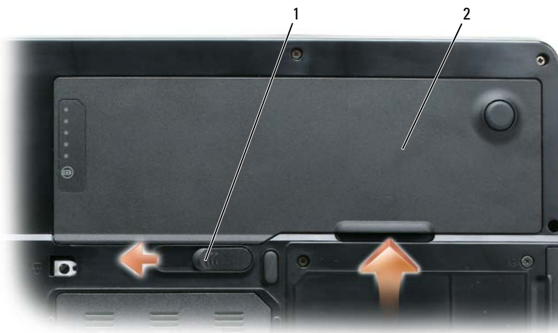
1 Frigöringsspak för batterifacket 2 Batteri
